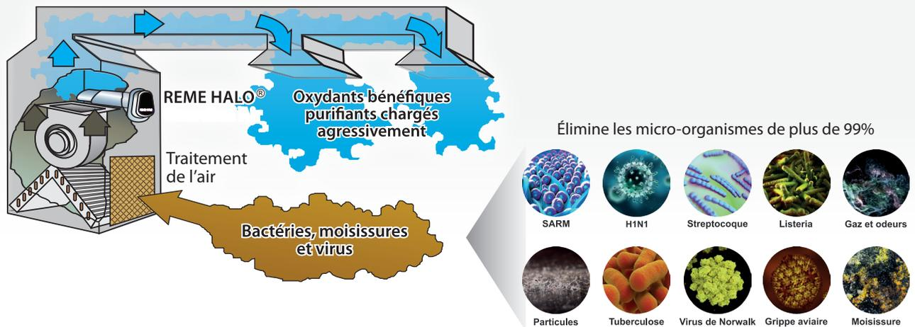
En fonctionnement, l'unité crée un plasma d'oxydation avancé composé de peroxyde d'hydrogène ionisé, d'ions superoxyde et d'ions d'hydroxyde. Tous ces oxydants bénéfiques reviennent à l'état d'oxygène et d'hydrogène après avoir oxydé un pathogène ou polluant.
