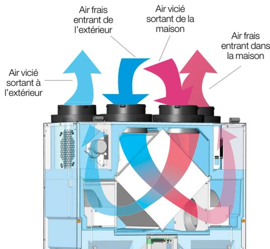
En été, c'est l'inverse : l'air chaud de l'extérieur est refroidi par l'air plus frais généré par le système de climatisation si l'air entrant est plus humide que l'air sortant, le VRE transfère l'humidité de l'un à l'autre. Cela permet de diminuer la charge de déshumidification du système de climatisation. Le VRE permet de diminuer l'apport en continu d'humidité dans l'air de la maison.
