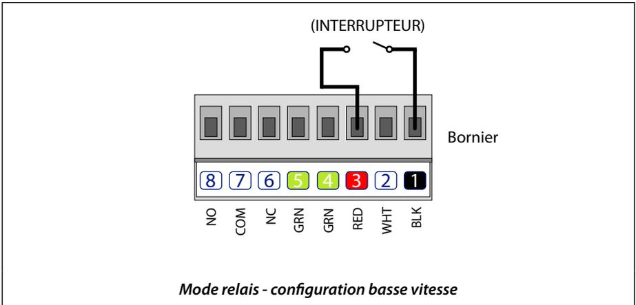
Si la basse vitesse n'est pas suffisante et que plus de ventilation est nécessaire pour répondre aux besoins de ventilation, branchez un cavalier entre les bornes 3 et 4, de plus, branchez les fils de l'interrupteur dans les bornes de connexion 1 et 4. Ce branchement permet d'activer le mode haute vitesse.
