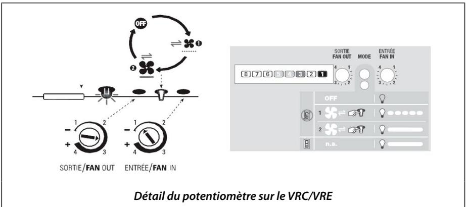
1. Pour régler le flux d'air frais (FAN IN) : Connectez les branchements comme le montre le diagramme ci-dessous et mettre le potentiomètre en mode FAN IN au niveau désiré.
