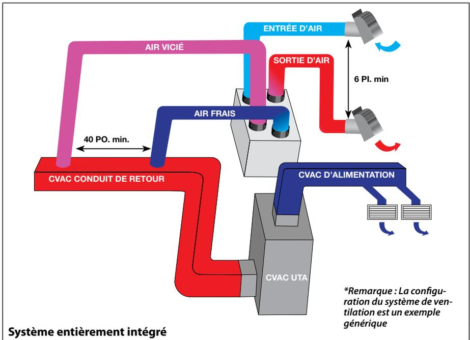
Le **Système entièrement intégré** permet d'extraire de l'air vicié du conduit de retour du système de chauffage et de refroidissement et réalimente en air frais extérieur le conduit de retour en amont. Une distance minimale de 40" (1 m) est recommandée entre les raccords. Reportez-vous à la section «Interconnexion du VRC/VRE et du système de chauffage /climatisation à air pulsé (UTA)» à la page 18.
