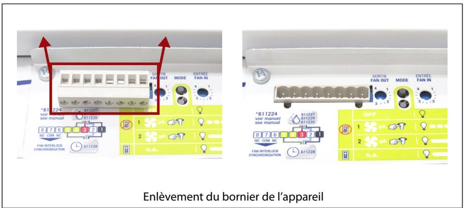
Enlèvement du bornier de l'appareil
