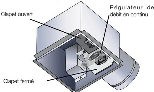
l'ouverture du clapet (interrupteur, minuterie, déshumidistat ou détecteur de présence). Une fois que le clapet est ouvert, le ZRT envoie un signal au VRC/VRE pour qu'il augmente la vitesse de débit de la ventilation, ce qui rend ce système idéal pour la ventilation des salles de bains.
