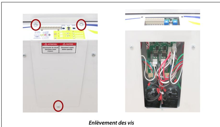
4. Une fois le couvercle retiré, localisez les broches du cavalier sur la carte électronique. Elles sont placées juste derrière les contrôleurs de la vitesse des moteurs, à l'avant de l'appareil.
