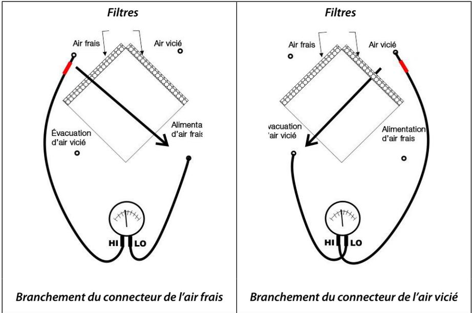
3. Répétez la mesure et le calibrage du débit d'air jusqu'à ce que les flux d'air frais et d'air vicié obtenus soient au niveau désiré.
