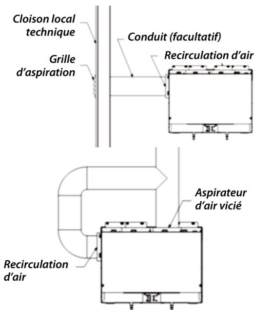
NOTE : cette option est compatible lors d'installation dans un local technique fermé avec présence d'équipements de combustion.
